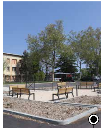
Place Mendès France, l'aménagement d'un îlot central et de bandes traversantes végétalisées permettent de diminuer la réverbération de la chaleur et d'améliorer l'infiltration des pluies.
